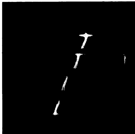
■図3 世界で初めてスパーク・チェンバーがとらえた宇宙線の飛跡を示す写真
